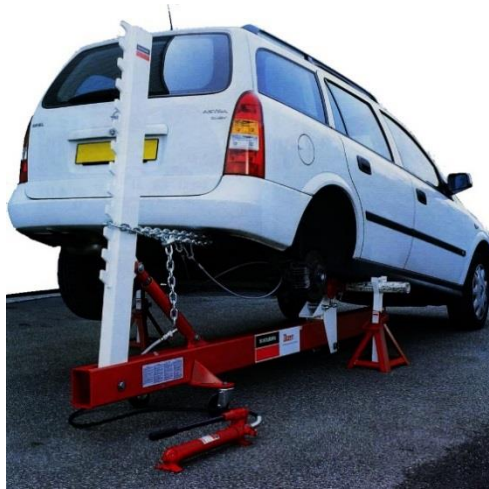
Obrázek 7: Dozer s dvěma prahovými svěrkami a propojovací silnostěnnou trubkou [24]
