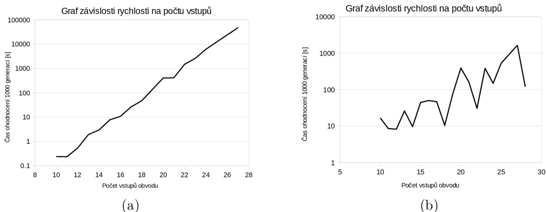
Obrázek 8.1: Obrázek ukazuje dvojici grafů, odpovídající implementovaným řešením (se SAT problémem a bez něj). Graf řešení s využitím simulace se nachází v části obrázku a). V části obrázku b) nalezneme závislost času potřebného k ohodnocení populace s pomocí SAT problému, zde však počet vstupů nehraje příliš velkou roli. Zobrazené hodnoty odpovídají času ohodnocení 1000 generací.
