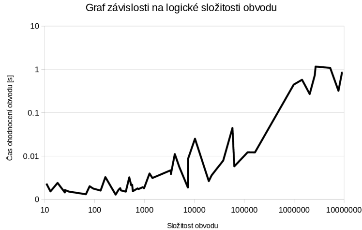
Obrázek 8.3: Graf závislosti rychlosti porovnávání výstupů referenčního a kandidátního obvodu na logické složitosti obvodu. Tento graf platí pro řešení počítající všechny výstupy najednou.
