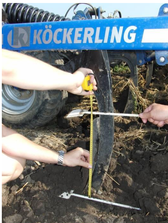
Obr. 17 Měření hloubky zpracování půdy
