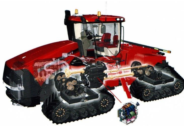
Obr. 9 Umístění převodovky v traktoru Steiger (1)
