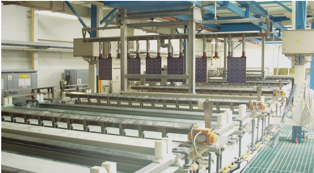
Obr. 6: Linka pro galvanické pokovení
