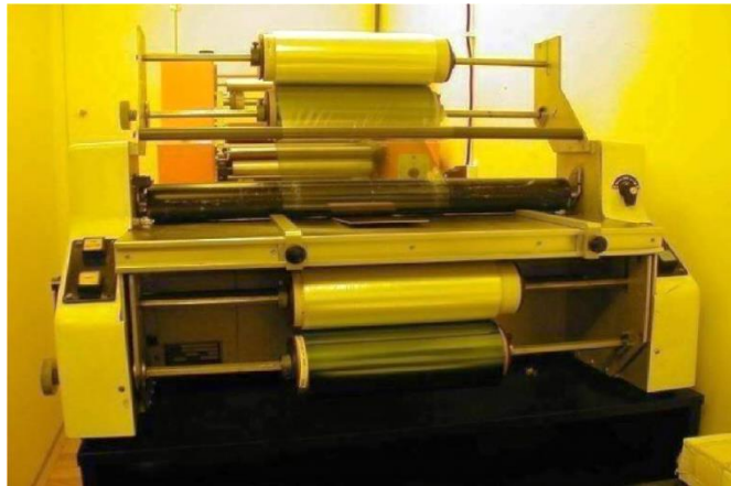
Obr. 3: Válcový laminátor tuhého negativního fotorezistu [9]
