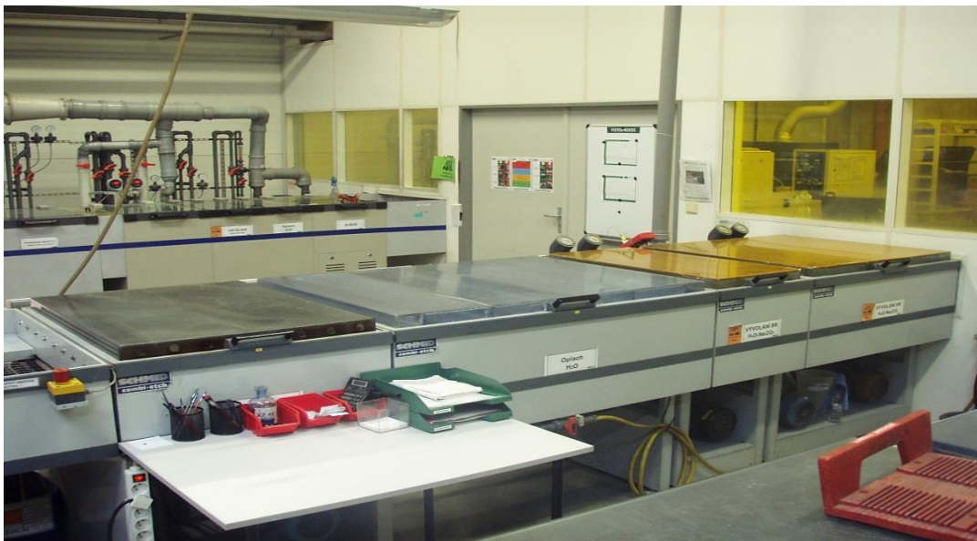
Obr. 5: Linka na vyvolání suchého fotorezistu
