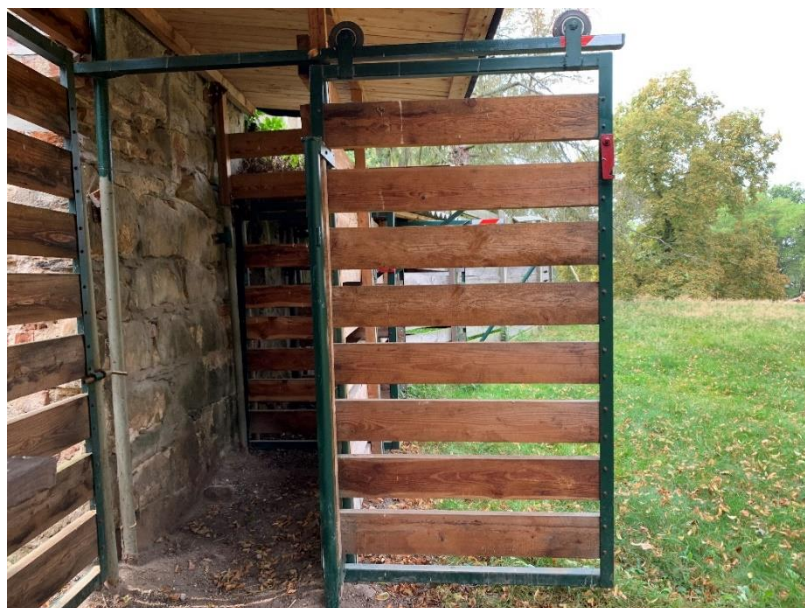
Obr. 71: Odchyťové zařízení, pohled na vysunutú dveře
