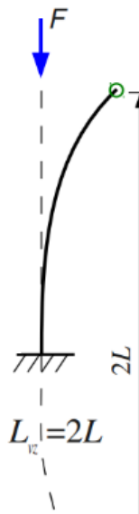
Obr. 53 Typ uložení – vzpěr [35]
