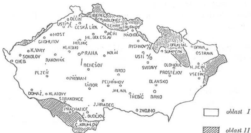
Obr. 1 – Hranice teplotních oblastí v zimním období dle ČSN 73 0540
