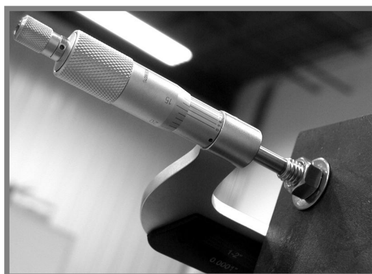
Obr. 25 Měření délky šroubu mikrometrem [34]
