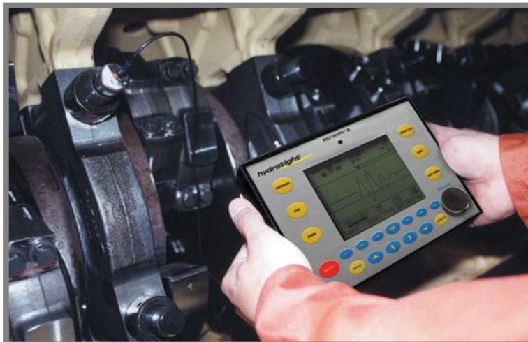
Obr. 26 Ultrazvuková kontrola předpětí [38]
