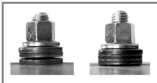
Obr. 22 Talířové podložky v neutaženém a utaženém stavu [34]
