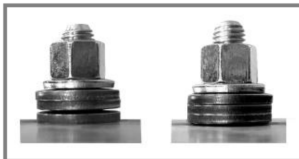
Obr. 22 Talířové podložky v neutaženém a utaženém stavu [34]
