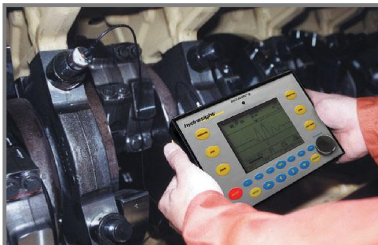
Obr. 26 Ultrazvuková kontrola předpětí [38]
