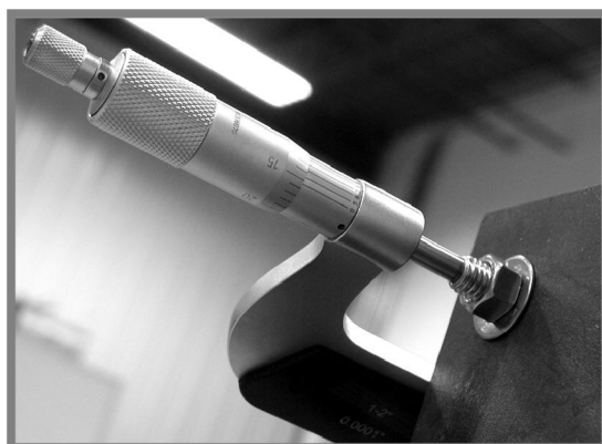
Obr. 25 Měření délky šroubu mikrometrem [34]
