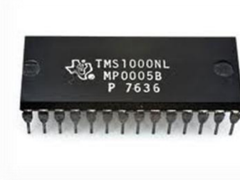
Obr. 4: Mikrokontrolér řady TMS 1000. [9]
