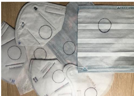
Obrázek 20 - Vzorky pro měření prodýchatelnosti masek
