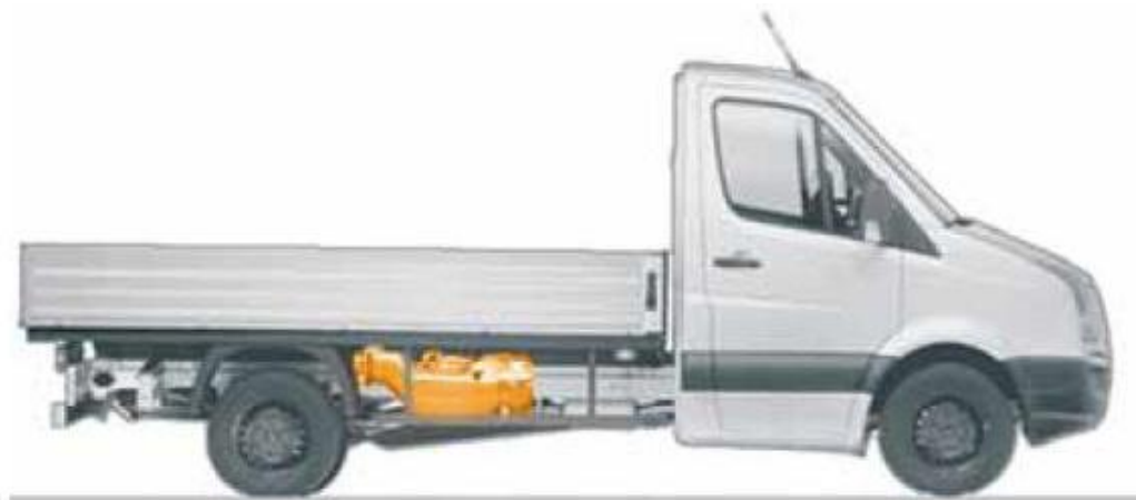
Obrázek 4-3: lehký užitkový automobil VW Crafter s SCR systémem [10]
