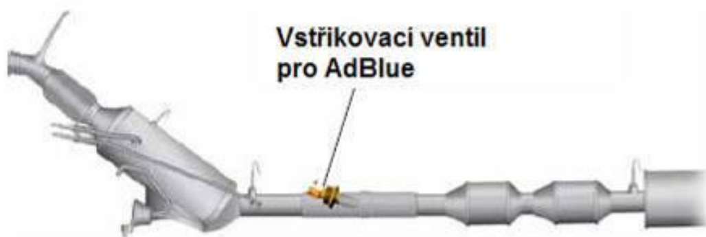
Obrázek 4-9: zástavba vstřikovacího ventilu na výfuku [10]
