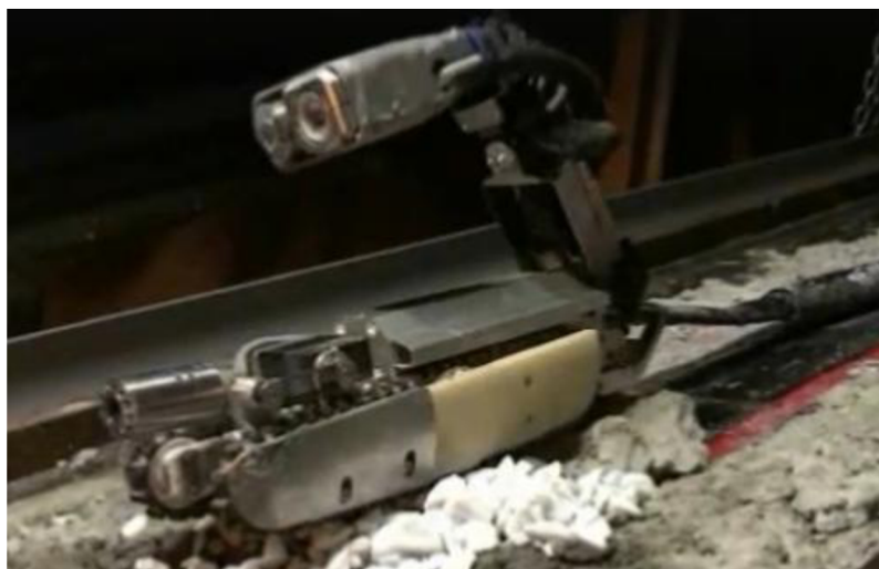
obr. 29 Robot SCORPION, zkoumání havárie elektrárny [28].
