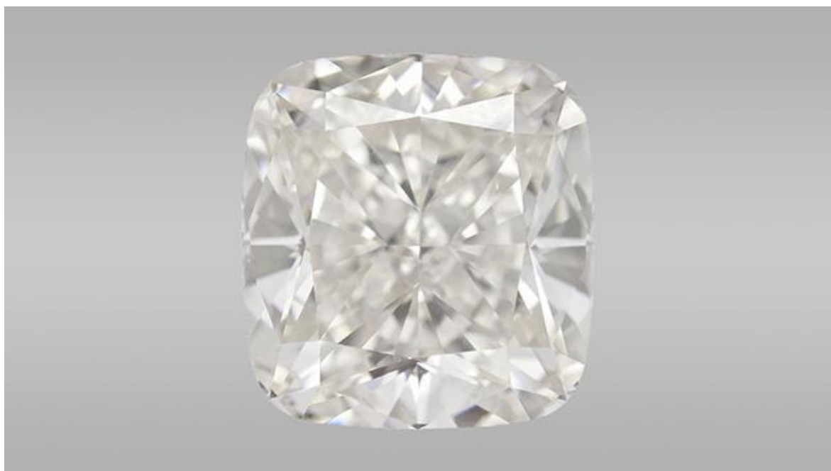
Obr. 14 Umělý pěti karátový diamant vyrobený metodou CVD [27].
