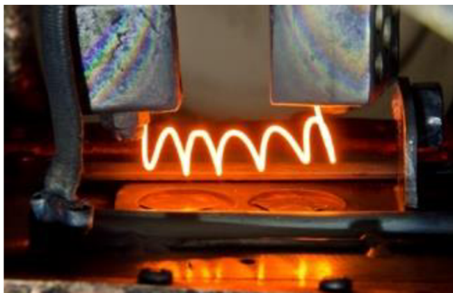
Obr. 3 Ohřátý wolframový drát, přes který je přiváděn plyn [16].
