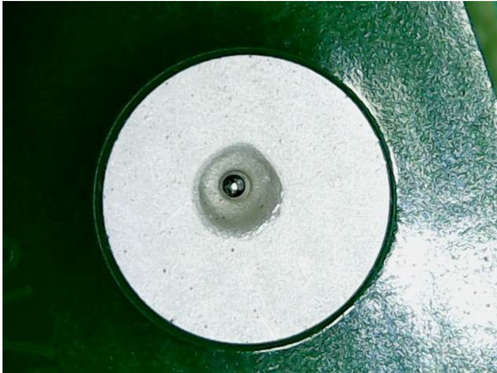
Obr. 7.1: Nanesené tavidlo a usazená kulička na plošce ošetřené imerzním cínem
