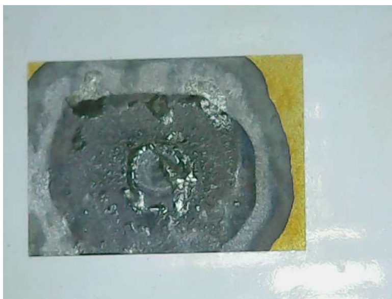
Obr. 8.3: Ploška povrchové úpravy ENIG po procesu pájení
