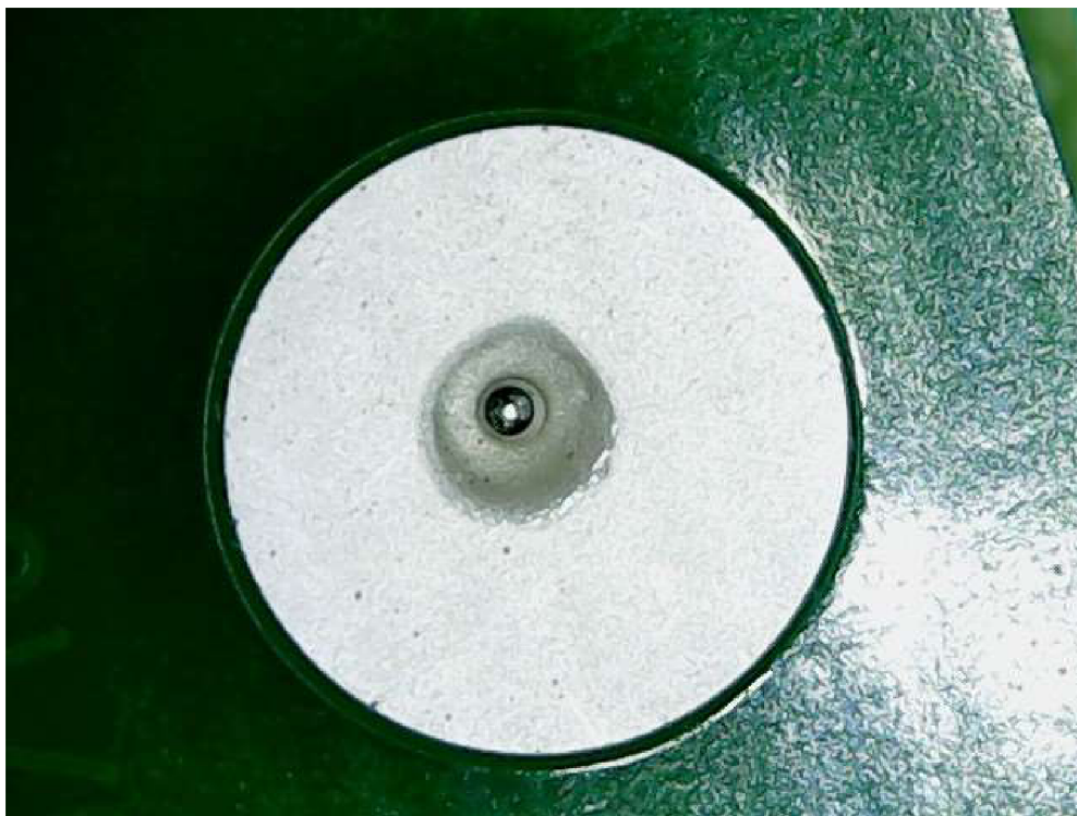
Obr. 7.1: Nanesené tavidlo a usazená kulička na plošce ošetřené imerzním cinem
