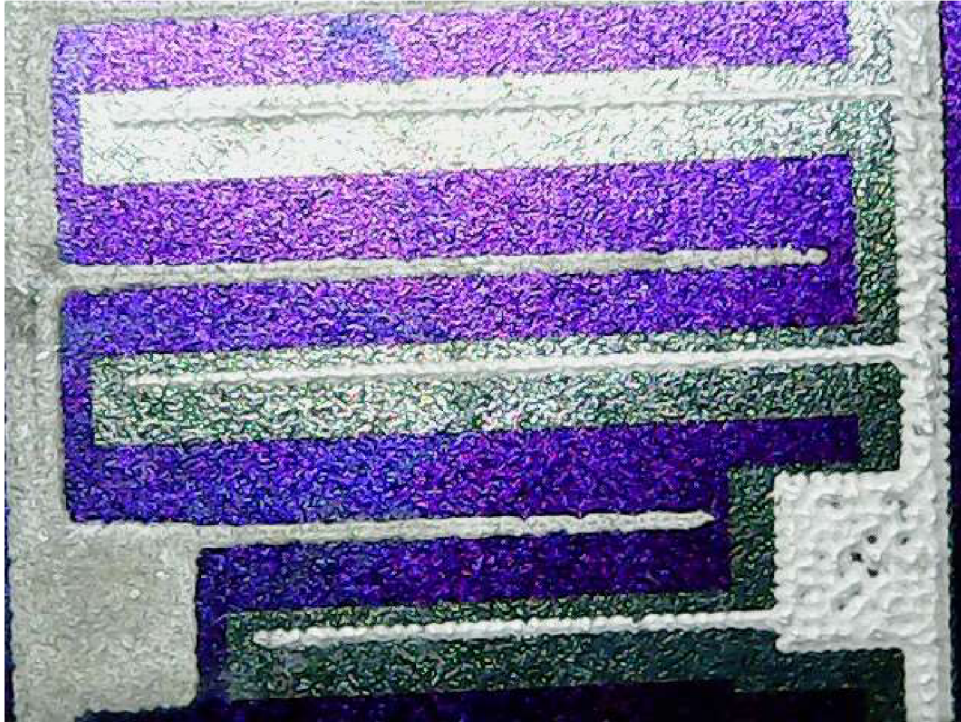
Obr. 8.2: Solární článek (vpravo a vlevo jsou pájecí plošky)
