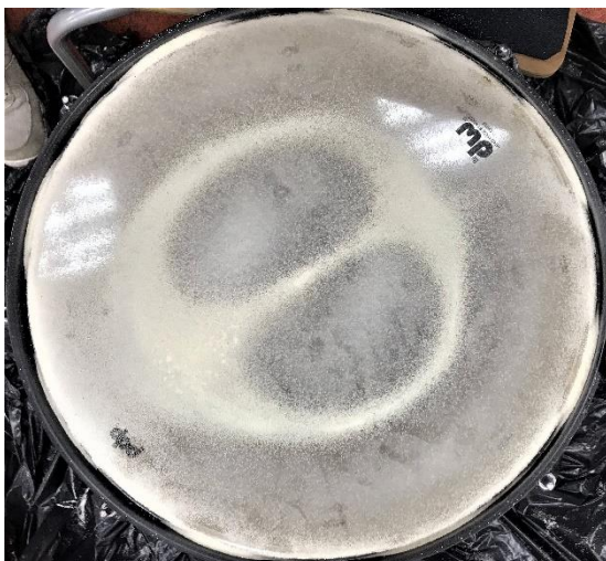
Obr. 3-3 Chladniho obrazce - 373 Hz
