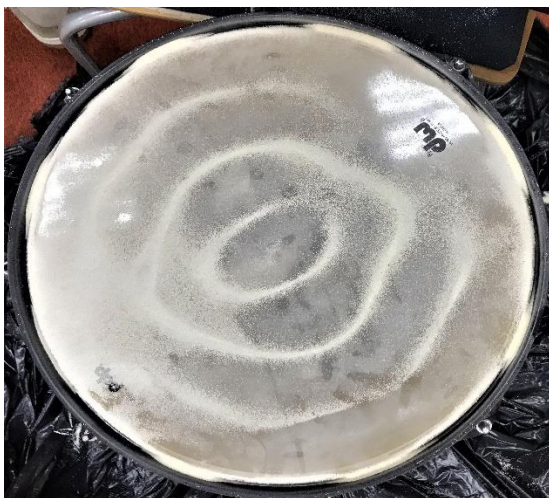
Obr. 3-4 Chladniho obrazce - 628 Hz
