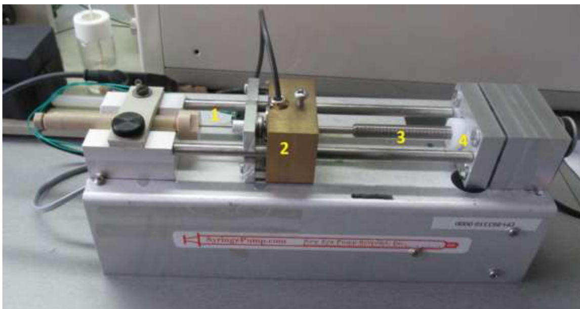
Obrázek 4 – Mechanická část stříkačkové pumpy po úpravě na axiální přenos hnací síly; 1 – píst stříkačky, 2 – pohyblivá tlačná část se zabudovaným snímačem síly, 3 – broušený šroub, 4 – poháněná matice.
