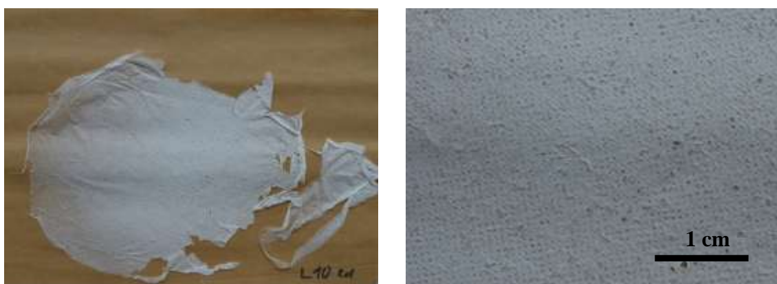
Obr. 48 – fotografické snímky nanovláken L10-7 zvlákněných poloprovozním zařízením po tepelné stabilizaci 2 h 180 °C
