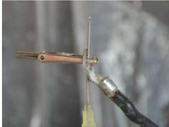
Obr. 27 – Detail jehly zařízení pro elektrostatické zvlákňování z jehly
