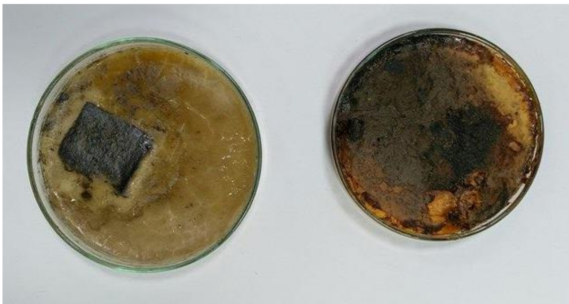
Obrázek č. 25 – Vlevo- stabilizovaný vzorek akrylu-> karbonizace při 400°C
