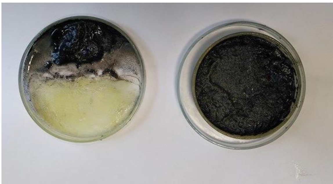
Obrázek č. 28 - Vlevo- stabilizovaný vzorek akrylu-> karbonizace při 550°C
