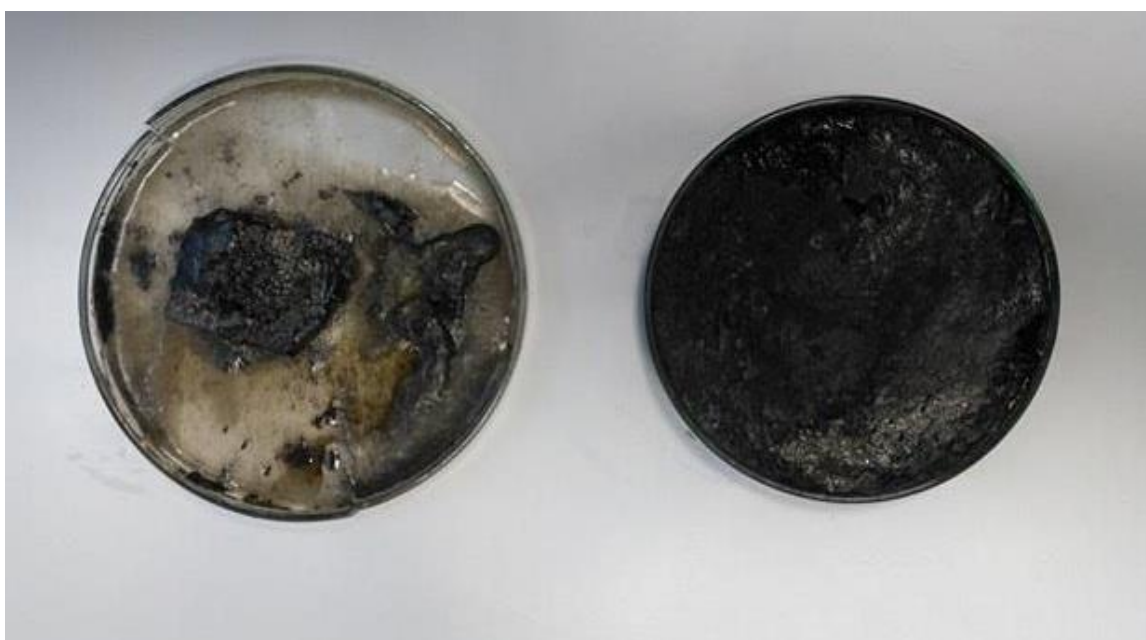
Obrázek č. 26 - Vlevo- stabilizovaný vzorek akrylu-> karbonizace při 450°C
