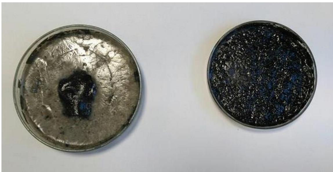
Obrázek č. 27 - Vlevo- stabilizovaný vzorek akrylu-> karbonizace při 500°C
