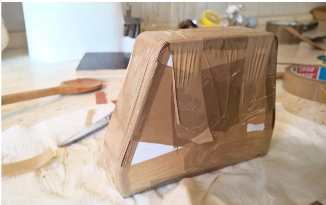
Obr. 46 - Namočený soubor dých zafixovaný na formě
