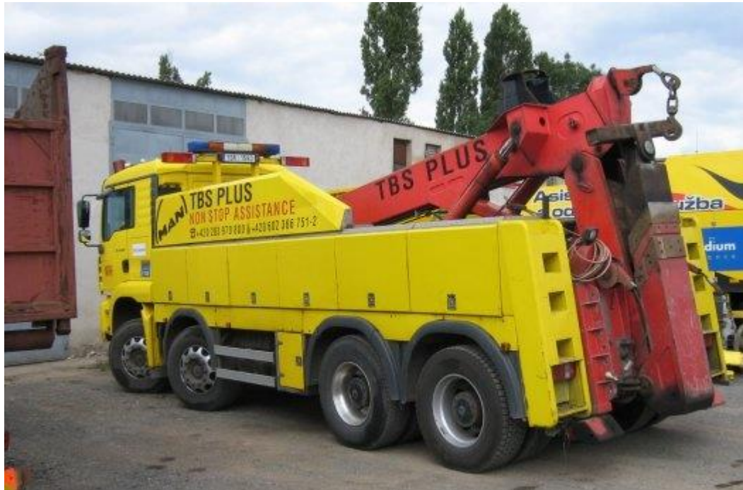
Obrázek č. 1: Vyprošťovací speciál s rozložením celkového počtu kol a počtu hnaných kol 8x4 [20]
