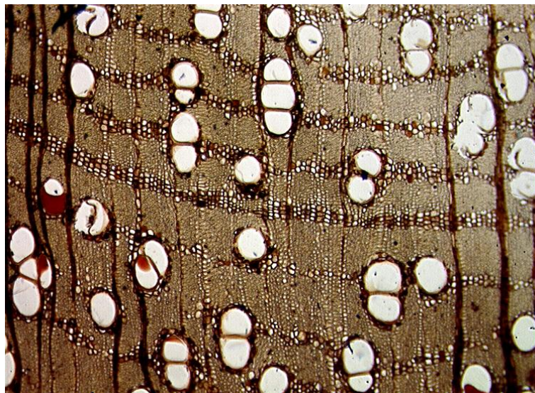
Obr. 4: Mikroskopická stavba mahagonu v P řezu: (internetová stránka, lexikon dřev)
