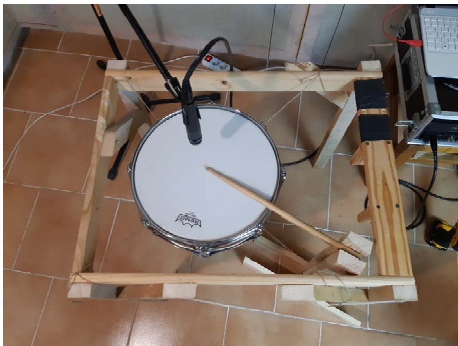
Obr. 8: Upnutí bubnu k dřevěnému rámu, instalovaný padací mechanismus (archiv autora)
