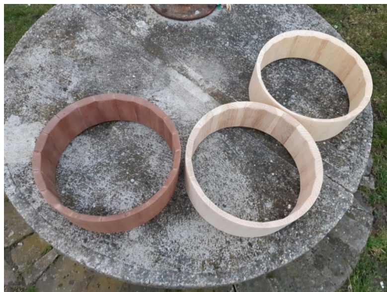
Obr. 26: Povrchová úprava – korpusy před nátěrem voskovým olejem (archiv autora)
