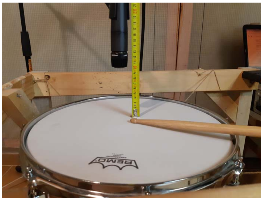
Obr. 10: Instalace snímacího zařízení - mikrofonu (archiv autora)
