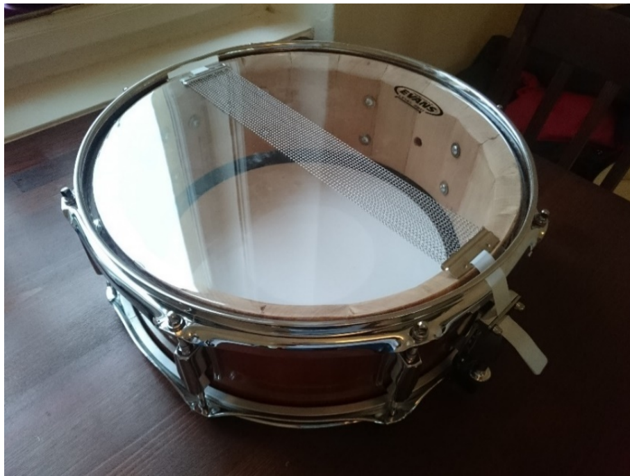
Obr. 31: Buben z vertikálních bloků z mahagonu, vyrobený 2020 – spodní stran (archiv autora)
