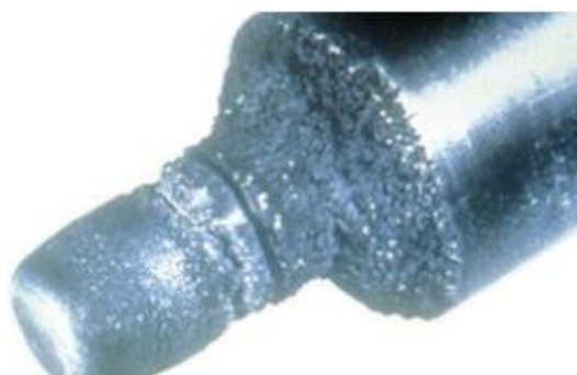
Obr. 11.1 Kavitační poškození vnitřní části ventilu [15]
