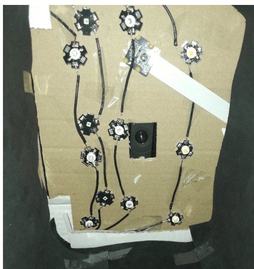
Obrázek 6.2: Umístění LED diod a kamer v prototypu
