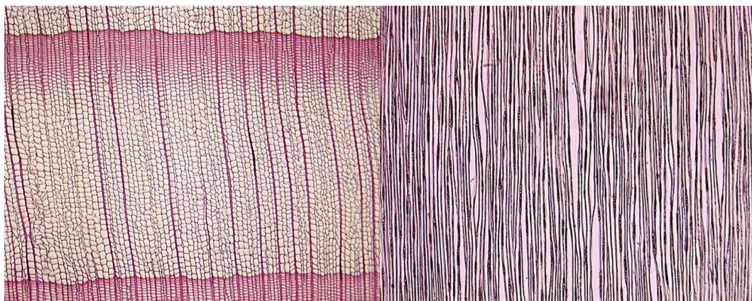
Obr. 27: Příčný a tangenciální řez mikroskopického vzorku jedle, absence pryskyřičných kanálků ( www.ldf.mendelu.cz )
