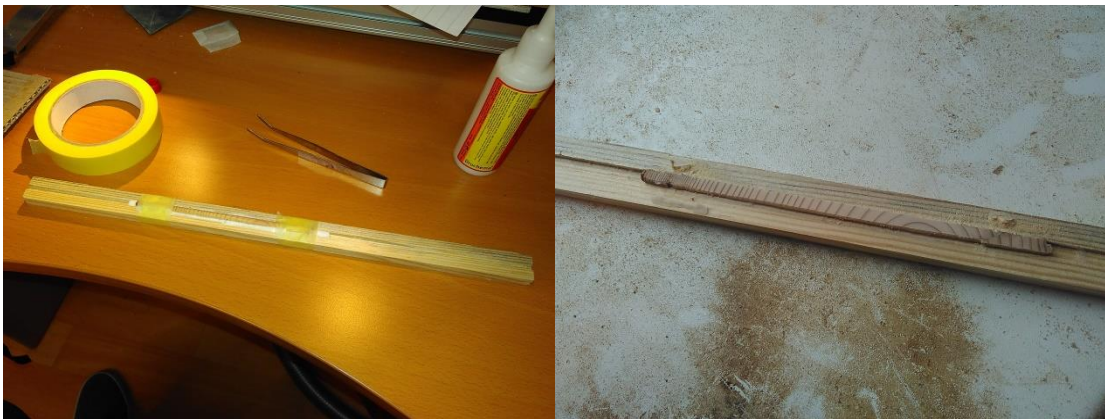
Obr. 15: Dřevěná lišta s nalepeným vzorkem a vybroušený vzorek připravený k měření
