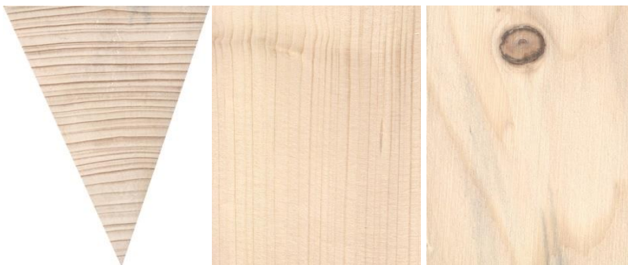
Obr. 4: Příčný, radiální a tangenciální řez smrku ( www.ldf.mendelu.cz )
