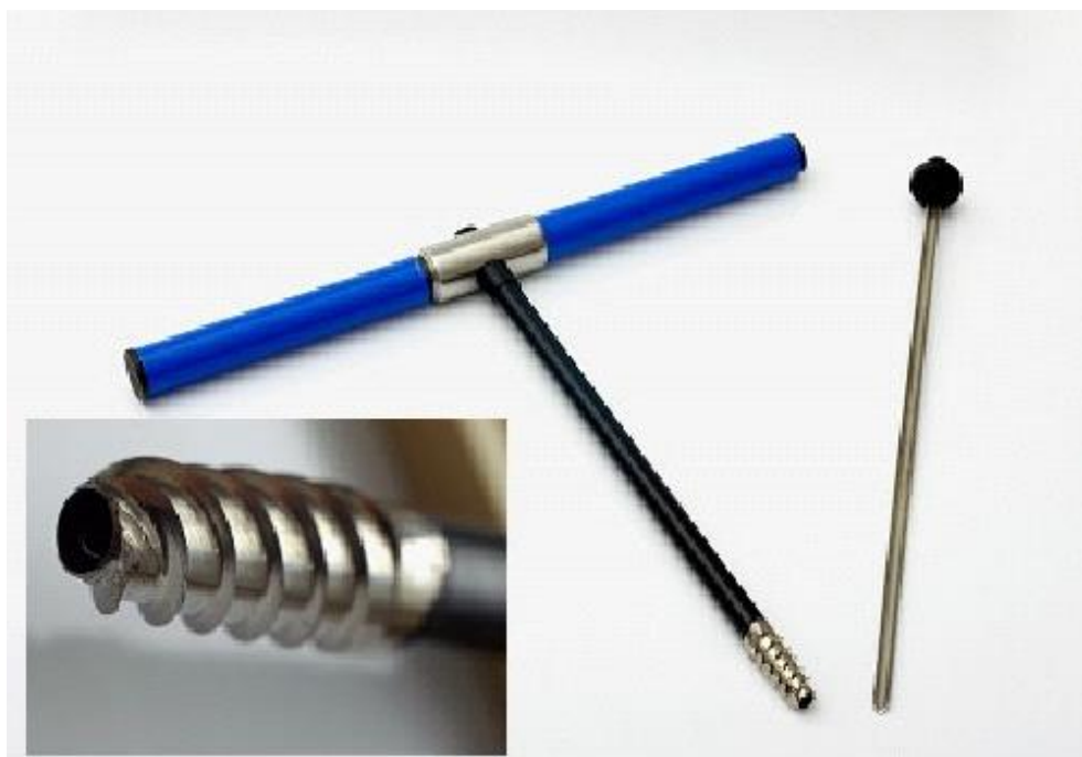
Obr. 14: Složený Presslerův přírůstkový nebozez s kovovou lžičkou (Rybniček 2007)
