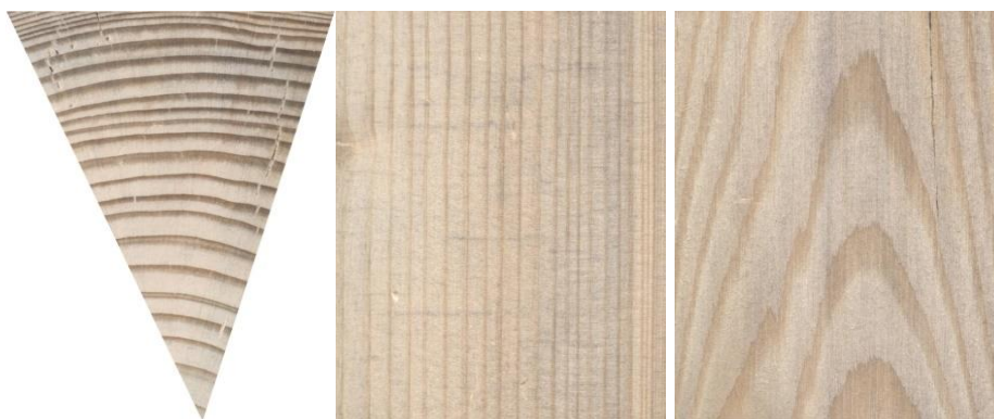
Obr. 5: Příčný, radiální a tangenciální řez jedle ( www.ldf.mendelu.cz )
