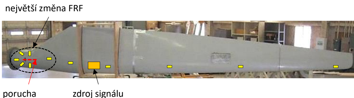
Obr. 5.4 Lopatka větrné turbíny osazená MFC snímači
