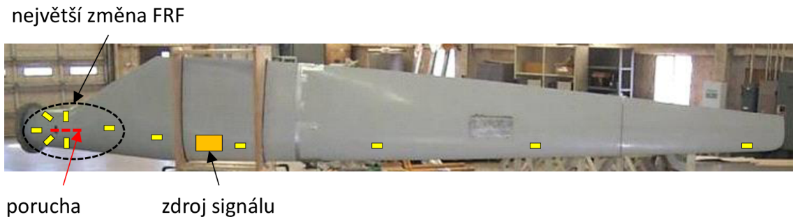
Obr. 5.4 Lopatka větrné turbíny osazená MFC snímači
