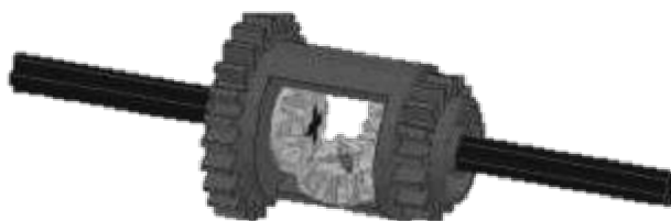
Obr. 5 Schéma čelního diferenciálu [5].
