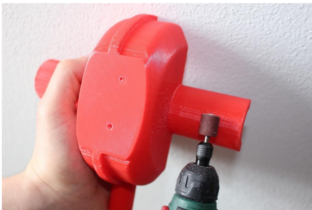
Obr. 28 Broušení hrubého povrchu v místě podpěr.
