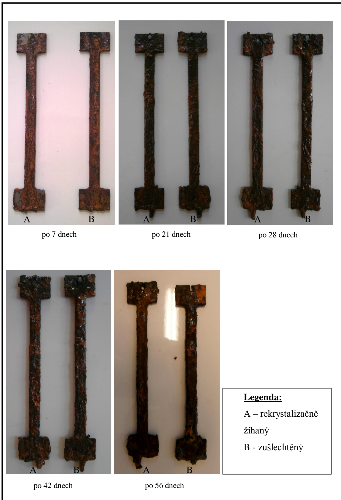
Obr. 26: Stav tahových destiček vystavených agresivním podmínkám v solné mlze [autor]
