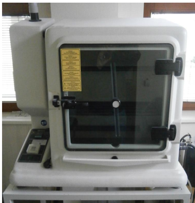
Obr. 16: Kondenzační komora s SO 2 [autor]
