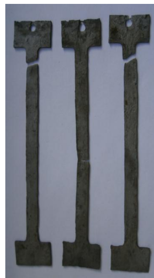
Obr. 31: Tahové destičky po tahové zkoušce [autor]
