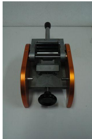
Obr. 19: Zařízení pro zkoušku ohybem [29]
