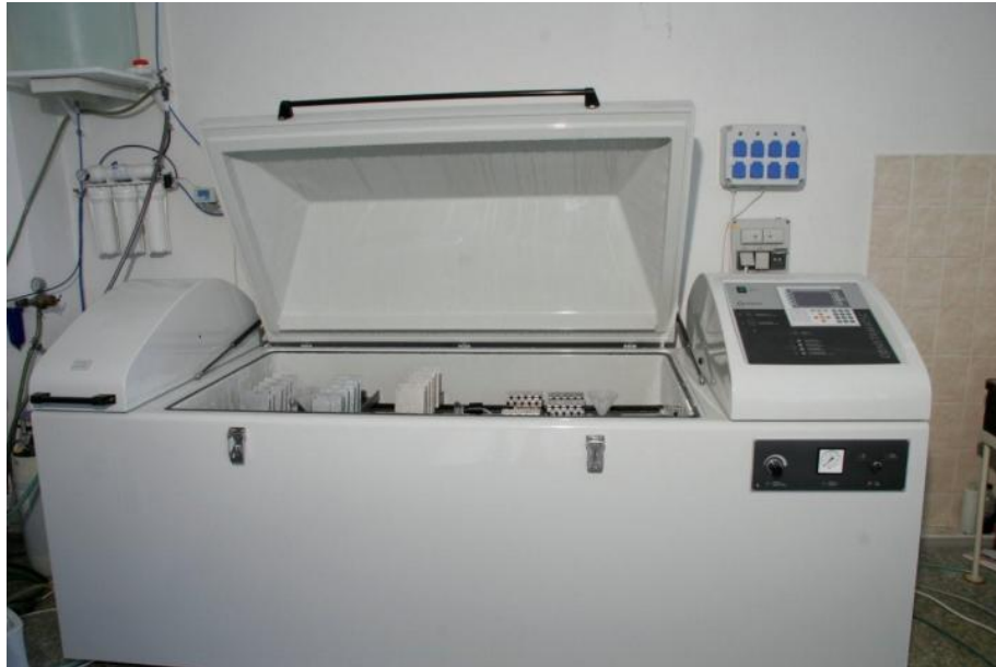
Obr. 14: Komora pro zkoušky za působení solné mlhy [23]
