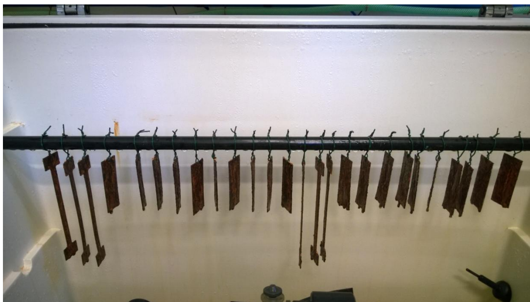
Obr. 24: Umístění a uspořádání vzorků v korozní komoře [autor]
