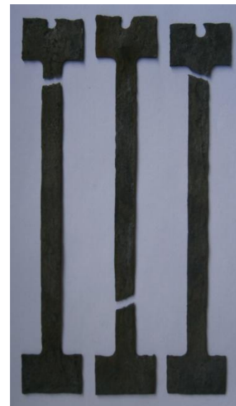
Obr. 33: Tahové destičky po tahové zkoušce [autor]
