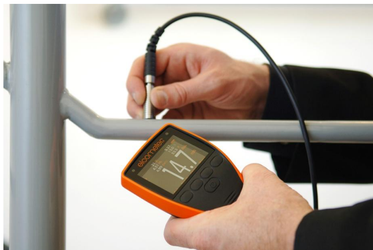
Obr. 20: Měření tloušťky nátěrové hmoty ELCOMETREM [29]
