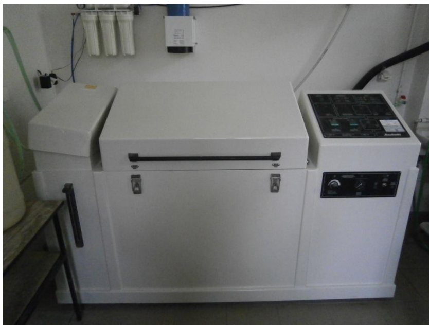
Obr. 23: Použitá korozní komora pro korozní zkoušku solnou mlhou [autor]
