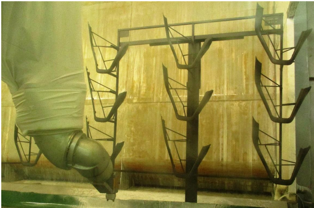
Obr. 23: Lakovací robot a díly na lakovacím závěsu (JIGu) v lakovací lince
