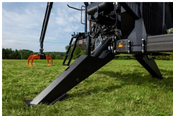
Obr. 14 Hydraulicky ovládané sklápěcí opěrné nohy [16]
