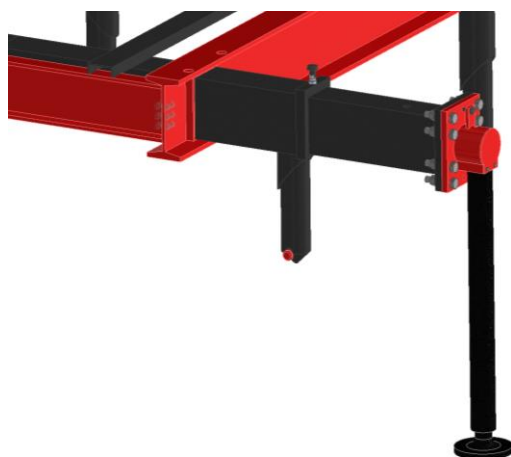
Obr. 43 Výsuvné rameno s přímočarým hydromotorem
