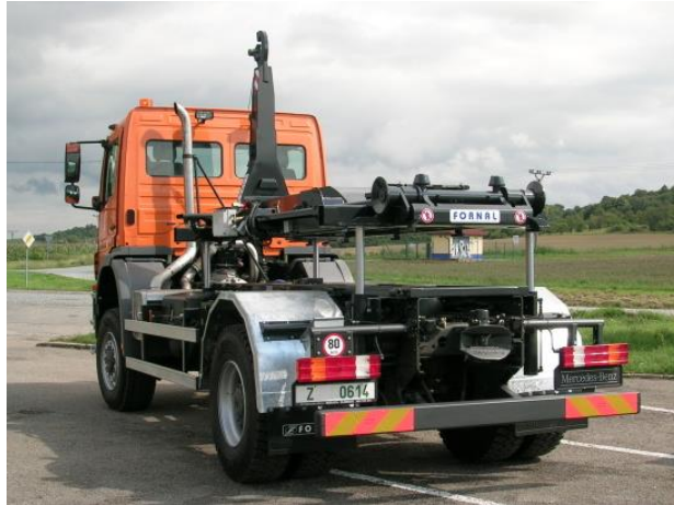
Obr.30 Nosič výměnných nástaveb na vozidle [38]
