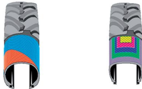
Obr. 12 Přídavný hydromotor s chladičem [16] Obr. 13 Diagonální (vlevo) a radiální (vpravo) pneumatika [19]
