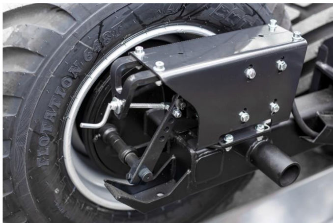
Obr. 10 Vzduchem ovládaná bubnová brzda [21]
