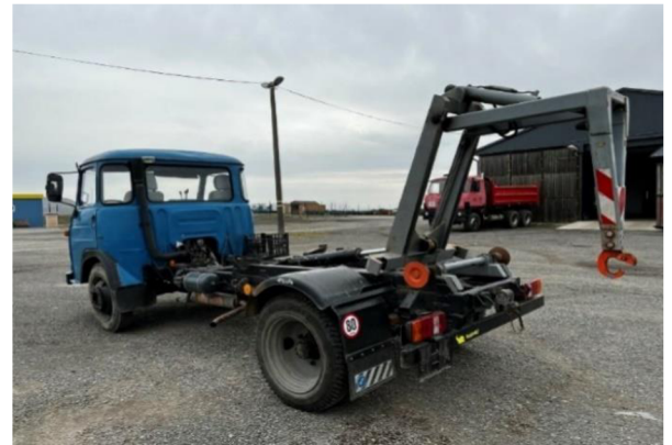
Obr. 35 Dvoukloubový hákový systém „S“ [42]
