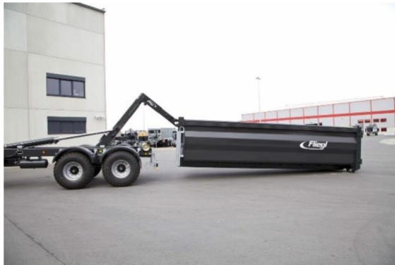
Obr. 34 Dvoukloubový hákový systém „T“ [41]
