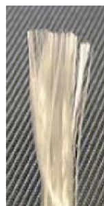
Obrázek 8. Tkanina v plátnové vazbě [6] Obrázek 9. Příze ze skelných vláken [6]
