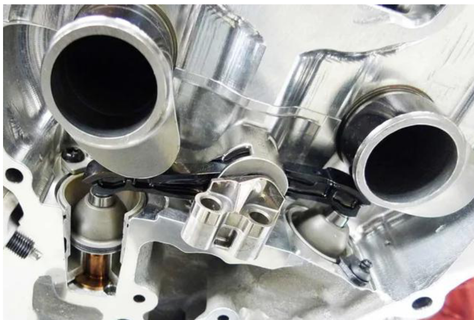
Obr. 2.17: Rozvod DOHC s vahadlem a pneumatickou pružinou [30]
