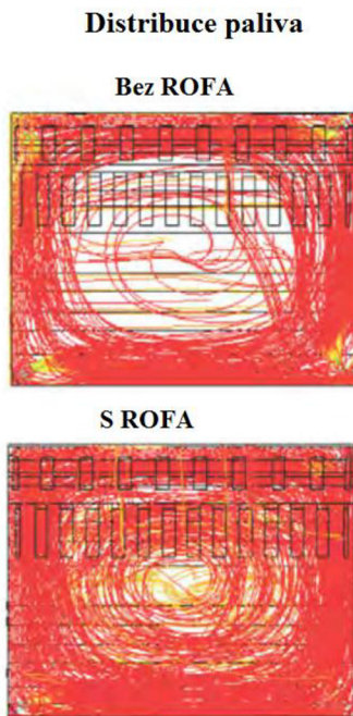
Obr. 13: Rozložení paliva v kotli bez systému ROFA a se systémem [33].
