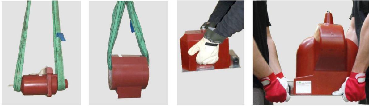
Obrázok 4 - Príklad správnej manipulácie podľa príručky ABB [2]
