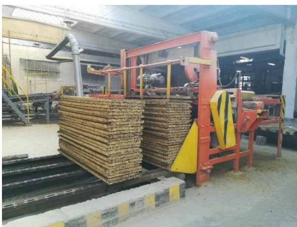
Obr. 19 Instalace štěpkocementové desky Izolox (autor)
