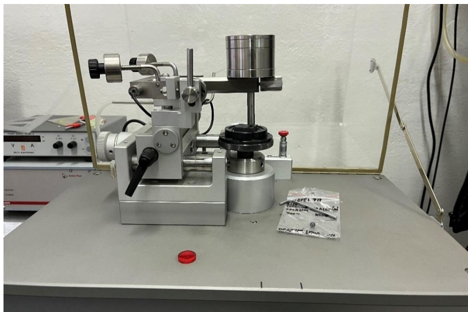
Obr. 22 Tribometr pro suché a kapalně prostředí
