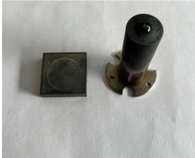
Obr. 24 Vzorek a kulička z materiálu \text{Si}_3\text{N}_4 upnuta v držáku
