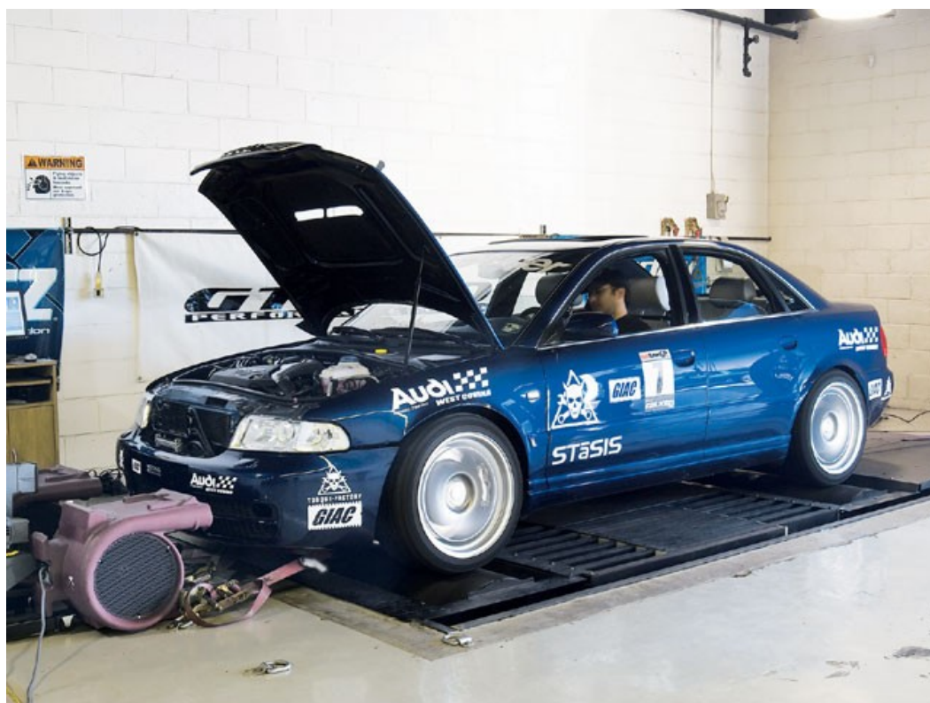
Obr. 9: Vůz Audi S4 na válcové brzdě pro brzdění vozidel s náhonem na všechna 4 kola
