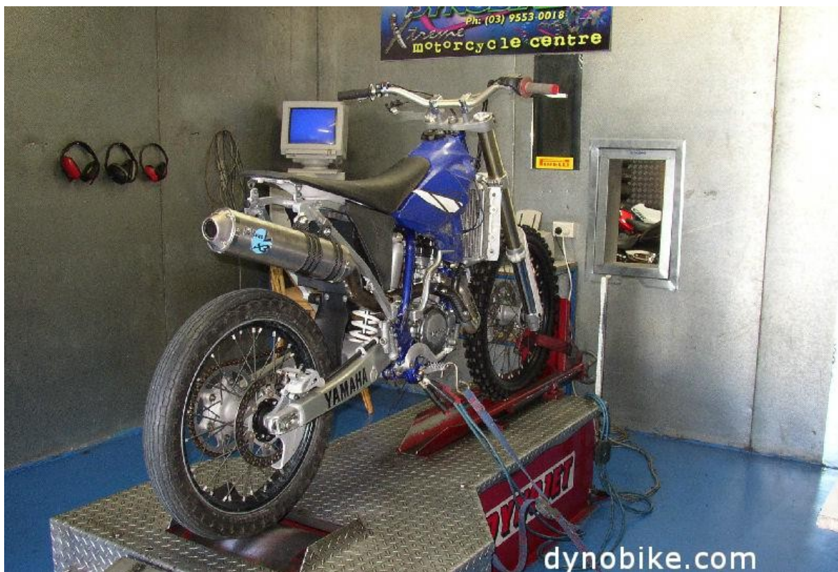
Obr. 8: Motocykl Yamaha na válcové motorové brzdě
