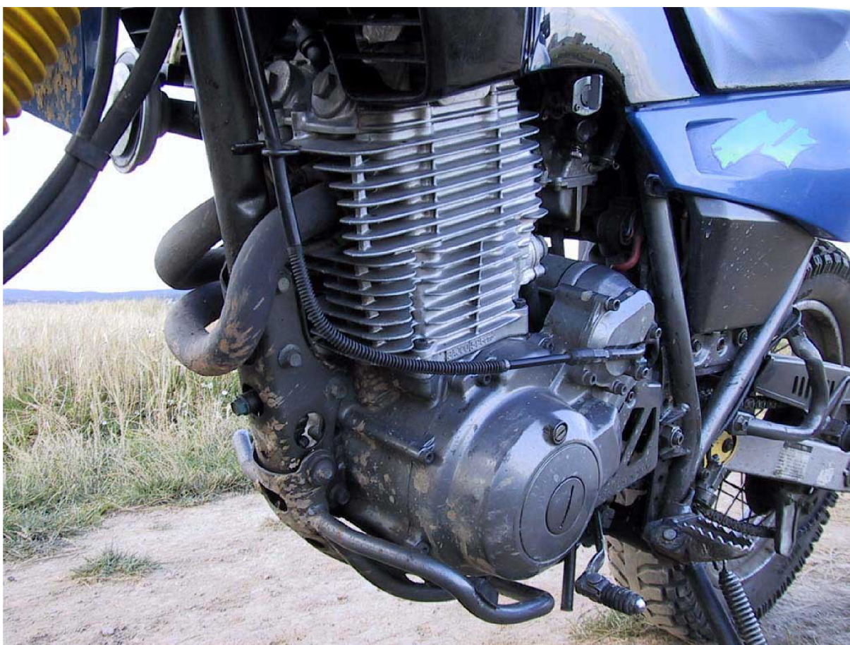
Obr. 5: Kompaktní konstrukce jednoválcového motoru v jednom bloku s převodovkou v motocyklu typu enduro, výrobce Yamaha
