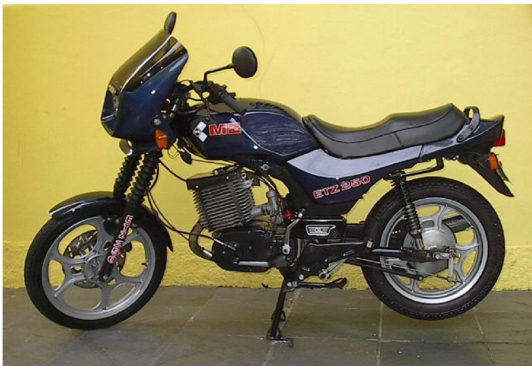
Obr. 6: Lehký dvoutaktní motor zavěšený v rámu motocyklu MZ
