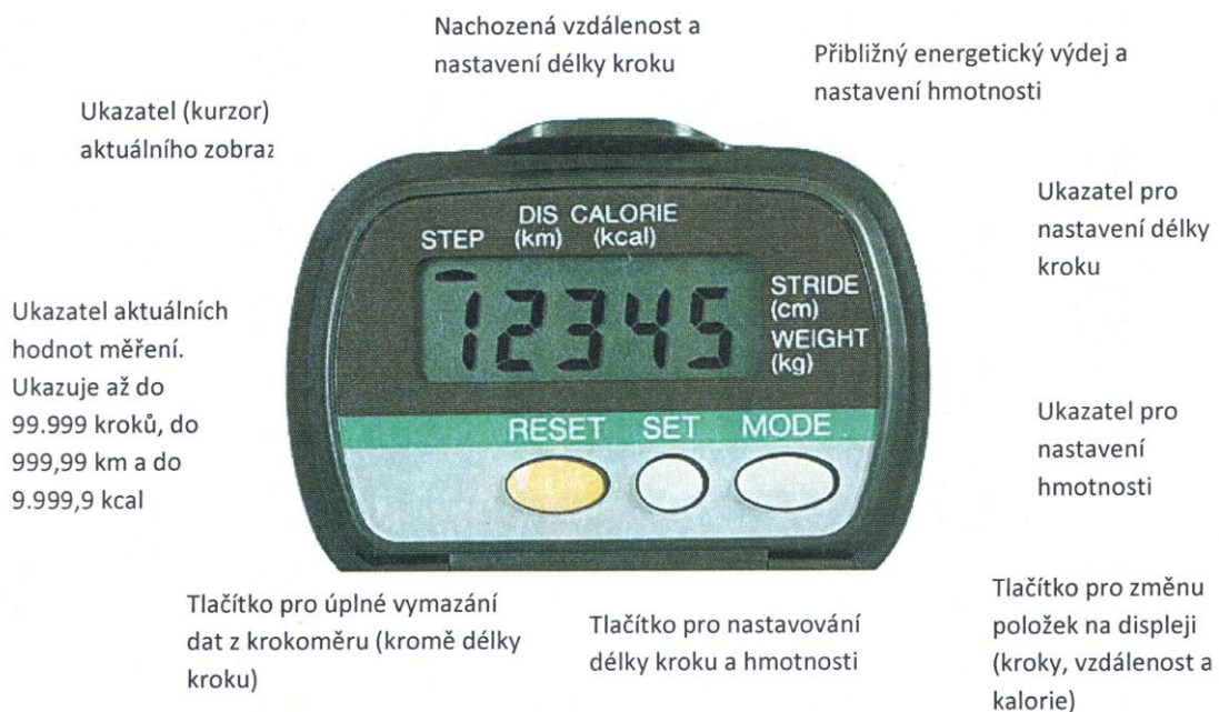
Obrázek 6 Popis displeje krokoměru Yamax SW 700 (Mitáš, 2008 s. 1)
