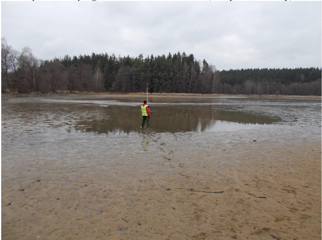
Obr.2: Rybník Panský – geodetické zaměření sedimentu, zdroj: foto Poslušný, 2014
