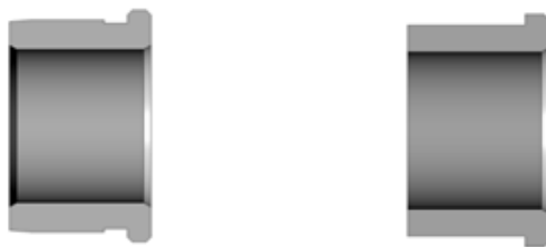
Obr. 12 – Geometrie vložky do pouzdra ventilu před úpravou (vlevo) a po úpravě (vpravo) pro CFD
