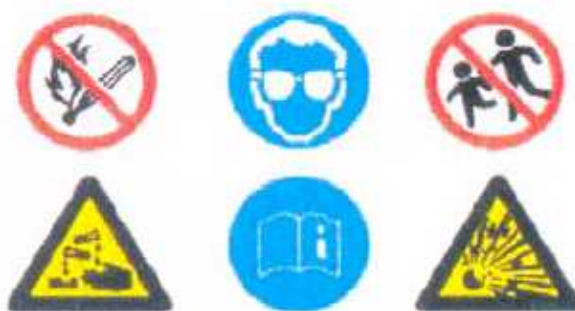
Obr. 13 Bezpečnostní štítkování akumulátorů barevnými značkami [7]
