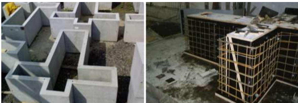
OBRÁZEK 95 VÝROBA BETONOVÝCH KŘÍŽŮ V BETONÁRCE PREFA KUŘIM. (FOTO PAVLA KAČÍRKOVÁ, 2006)
