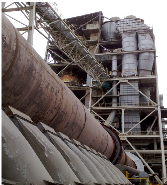
Obr. 5: Předehřívací zařízení (čtyřstupňový cyklonový výměník) s rotační pecí
