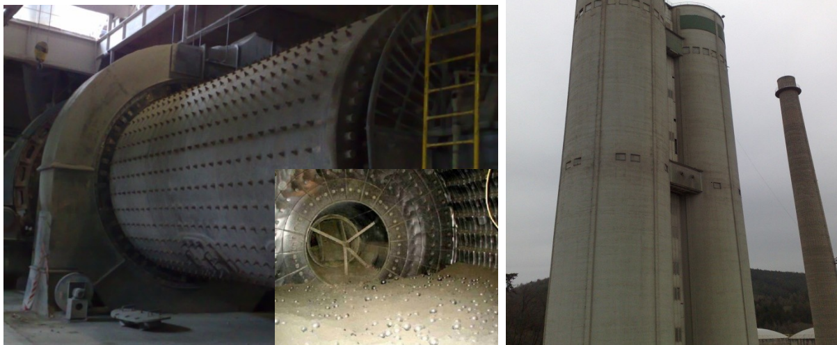
Obr. 4: Vlevo - surovinový mlýn, vpravo - homogenizační sila
