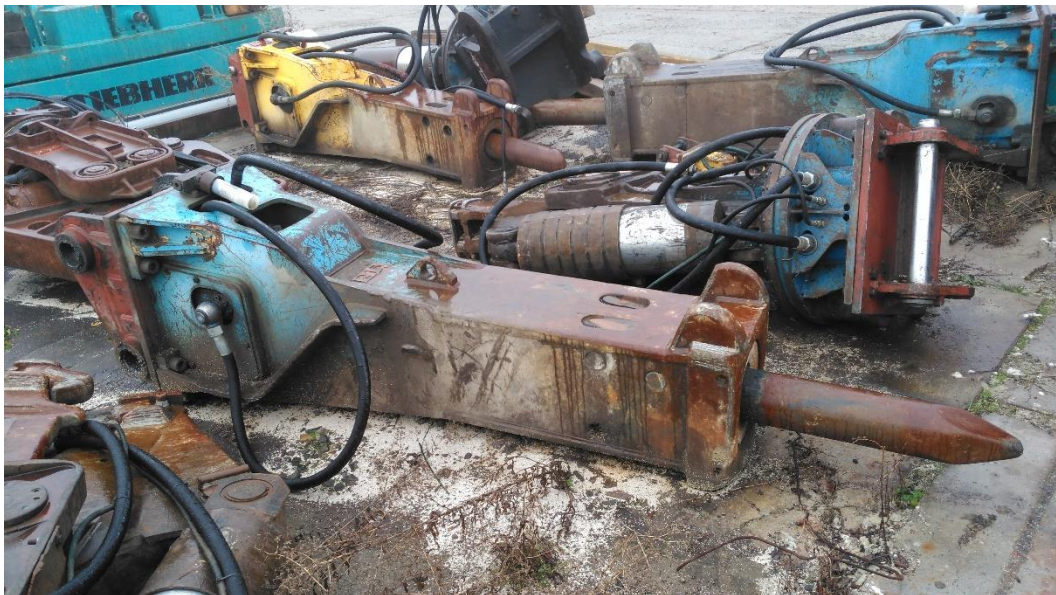
Obr. č. 4: Pneumatické demoliční kladivo
