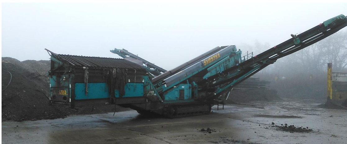
Obr. č. 15: Mobilní vibrační třídíč
