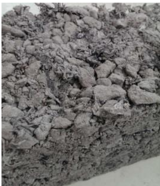
Obr. č. 16: Vzorek kompozitu s betonovým recyklátem
