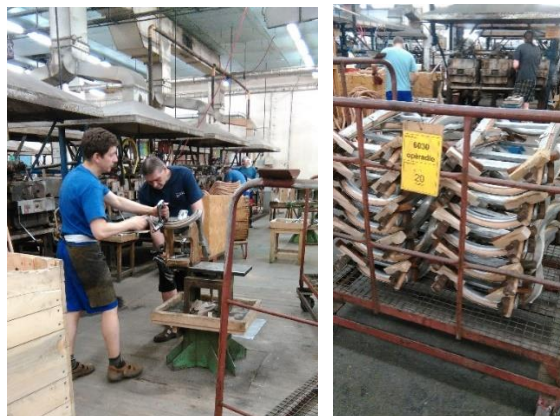
Obr. 53 Ruční ohýbání opěradla ve formách
