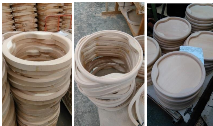
Obr. 59 Sedadlový rám s vnitřním ofrézovaným obvodem
