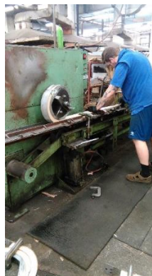
Obr. 55 Strojní ohýbání sedadlového rámu na ohýbacím stroji „sádlík“
