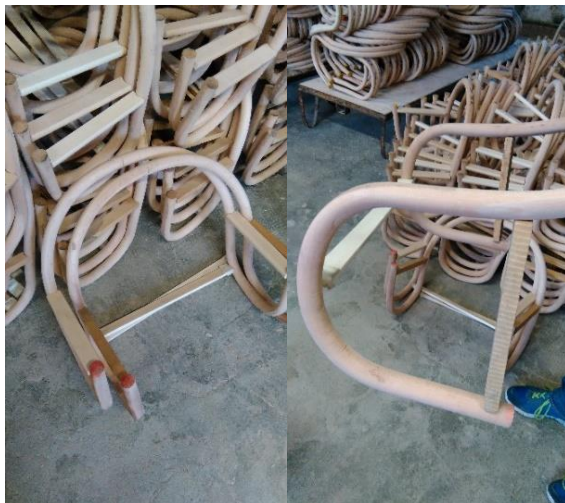
Obr. 63 Loketník s rozpěrami pro fixaci tvaru
