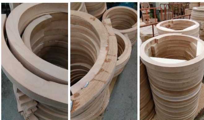
Obr. 56 Sedadlový rám s vyfrézovanými drážkami
