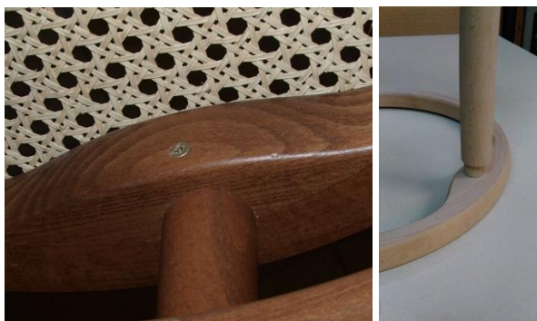
Obr. 64 Detail připevnění přední načepované nohy
