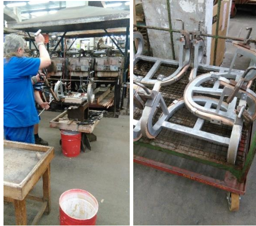
Obr. 51 Ruční ohýbání loketníku ve formě
