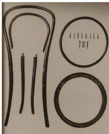
Obr. 19 Židle č. 14 – rozložená na části
